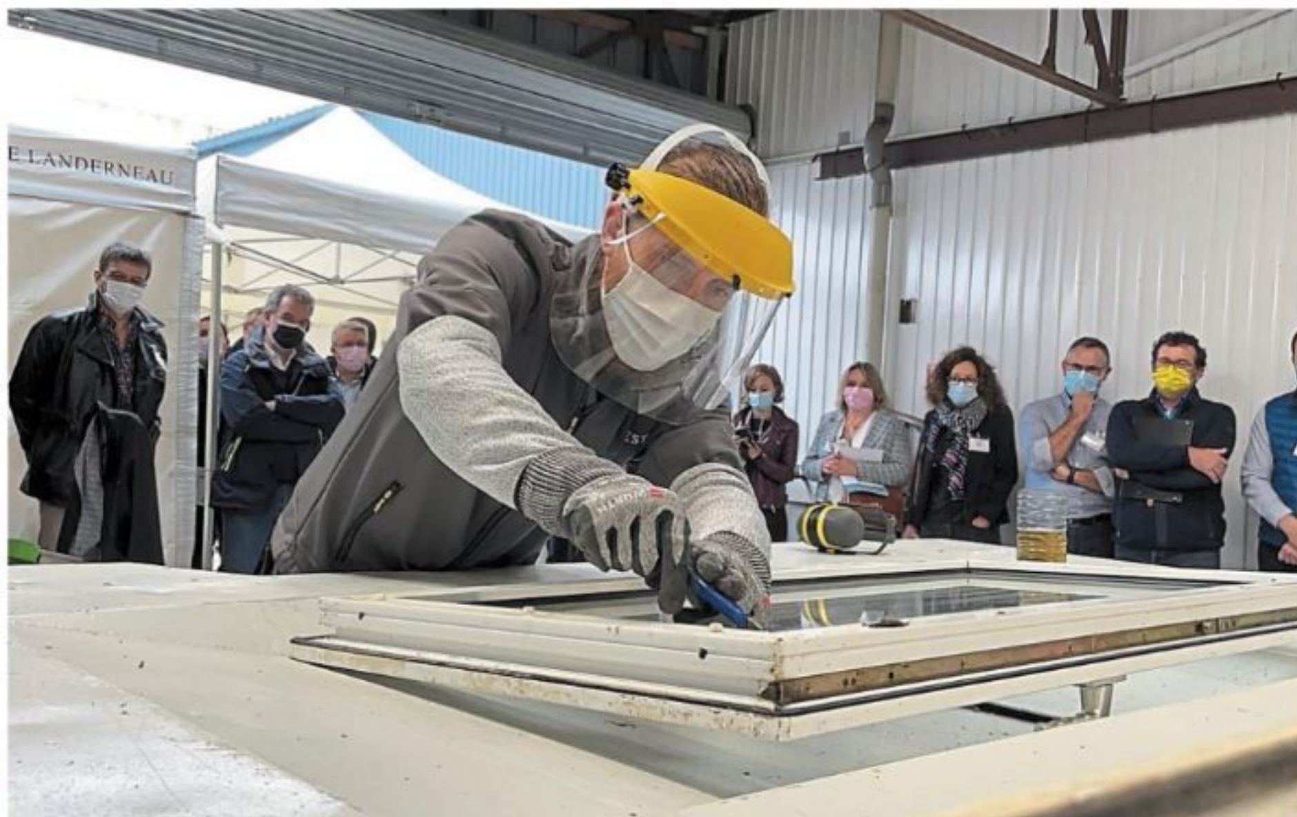
Un technicien découpe le verre plat, qui servira par la suite à remplacer, progressivement, le sable du bâtiment qui va disparaître dès 2050, pour protéger la ressource.
